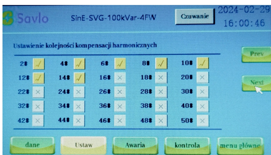
Rysunek 21. Ekran czwarty ustawień — kompensacja wyższych harmonicznych — wybór harmonicznych parzystych
