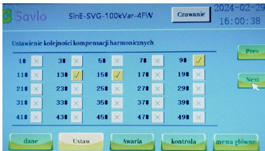
Rysunek 20. Ekran trzeci ustawień — kompensacja wyższych harmonicznych — wybór harmonicznych nieparzystych
