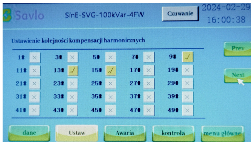
Rysunek 20. Ekran trzeci ustawień — kompensacja wyższych harmoniczných — wybór harmoniczných nieparzystych
