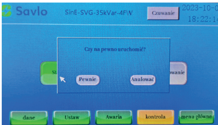
Rysunek 26. Uruchomienie manualne kompensatora
