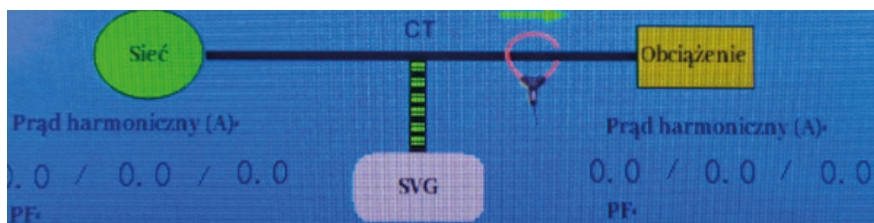
Rysunek 18. Ekran główny kompensatora przy przekładnikach od strony obciążenia/instalacji
