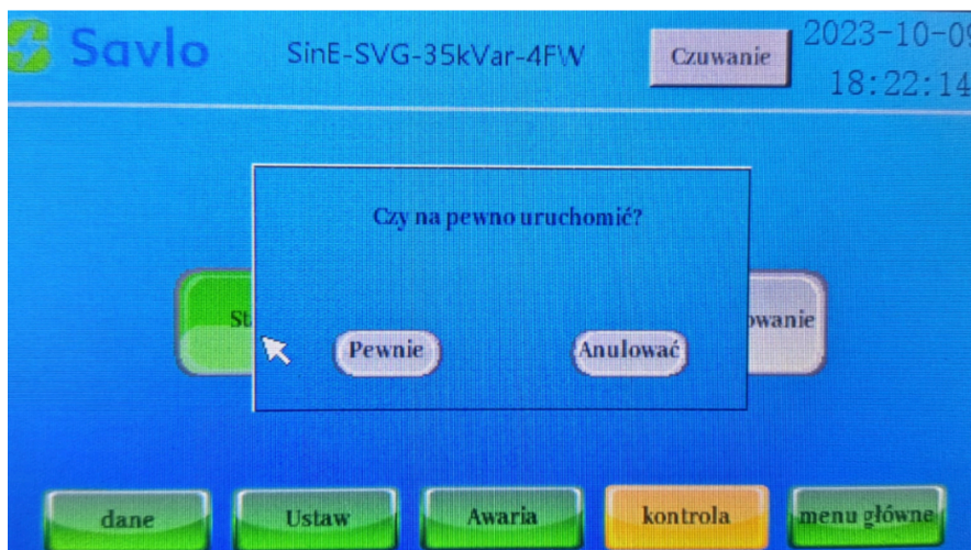
Rysunek 26. Uruchomienie manualne kompensatora
